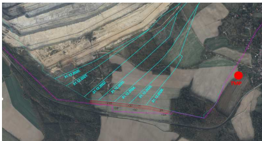
Obr. 2 Situace Dolu Turów se zakresleným plánovaným postupem rozšiřování dolu do roku 2026 (Zdroj: Prezentace „Analiza możliwości lokalizacji pasa zieleni izolacyjnej na przedpolu w celu zabezpieczenia zanieczyszczenia krajobrazu od strony Republiki Czeskiej”, 2021)
