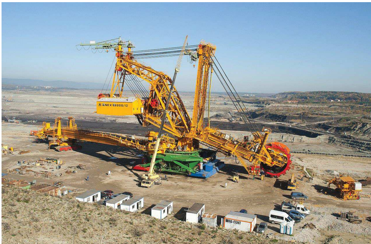
Obr. 3 Ukázka kolesového rypadla (nejde o typ používaný v dole Turów) (Zdroj: Wikipedie)
